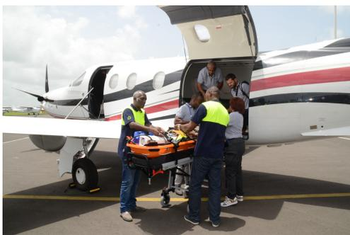
Le Pilatus est équipé d'une porte cargo standard en plus d'une porte principale pour le passage des patients allongés. Conçu pour permettre le chargement de grande capacité, il peut ainsi embarquer une civière sans difficulté ainsi que du matériel encombrant. La cabine passager est assez spacieuse pour permettre à 4 accompagnants d'y prendre place en plus du malade (position couchée).
